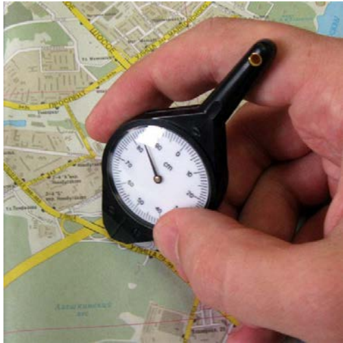
Рис. 7. Вимірювання курвіметром довжини лінії по карті
